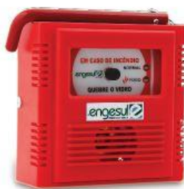
Figura 5 – Acionador manual endereçável quebre o vidro com sirene IP 20 Classe B. Fonte: Engesul
