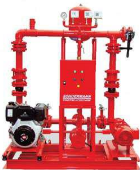
Figura 2 – Central de bombas para combate a incêndio, sistema montado e fornecido em “Skid”, composto por motobomba centrífuga elétrica e a combustão. Fonte: Schuermann
