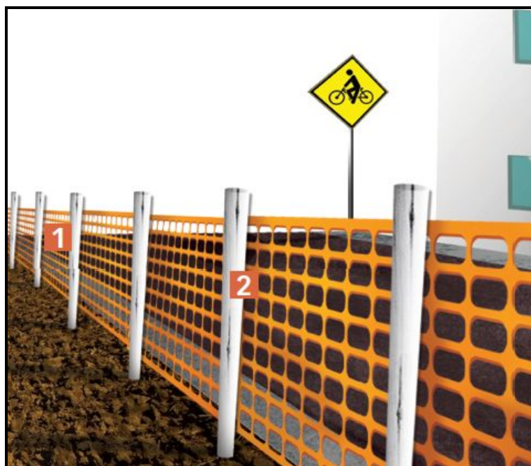
Figura 01 – Cerca de tela para isolamento de obra
