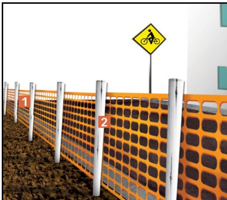
Figura 01 – Cerca de tela para isolamento de obra
